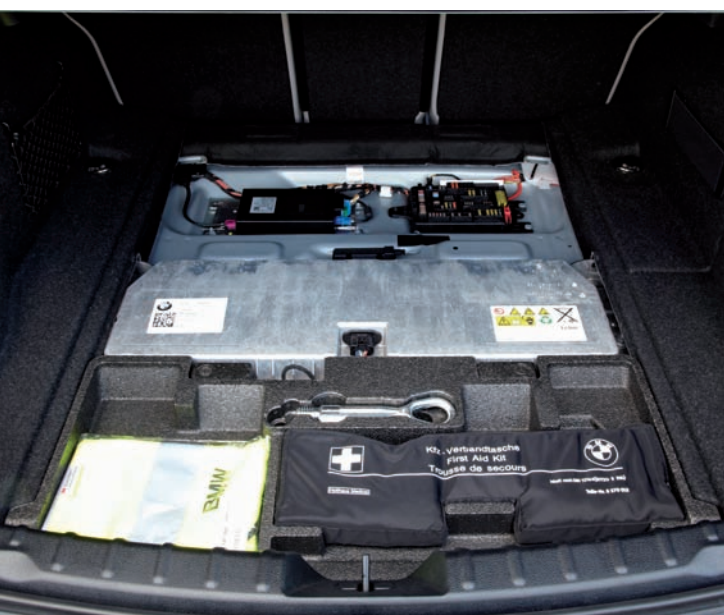
Batería de ión-litio de alto rendimiento, integrada debajo del maletero.
