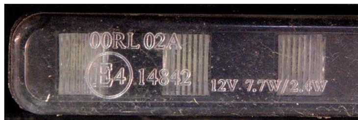
Figura 1: Ejemplo de marcado de luz diurna y luz de posición (00RL02A).
