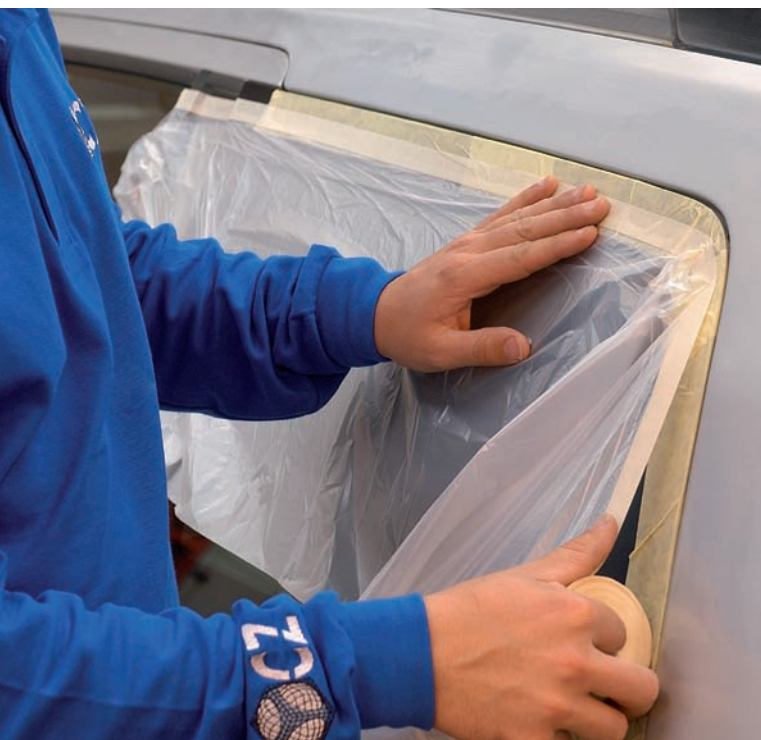
Enmascarado incorrecto de “fuera a dentro”.
