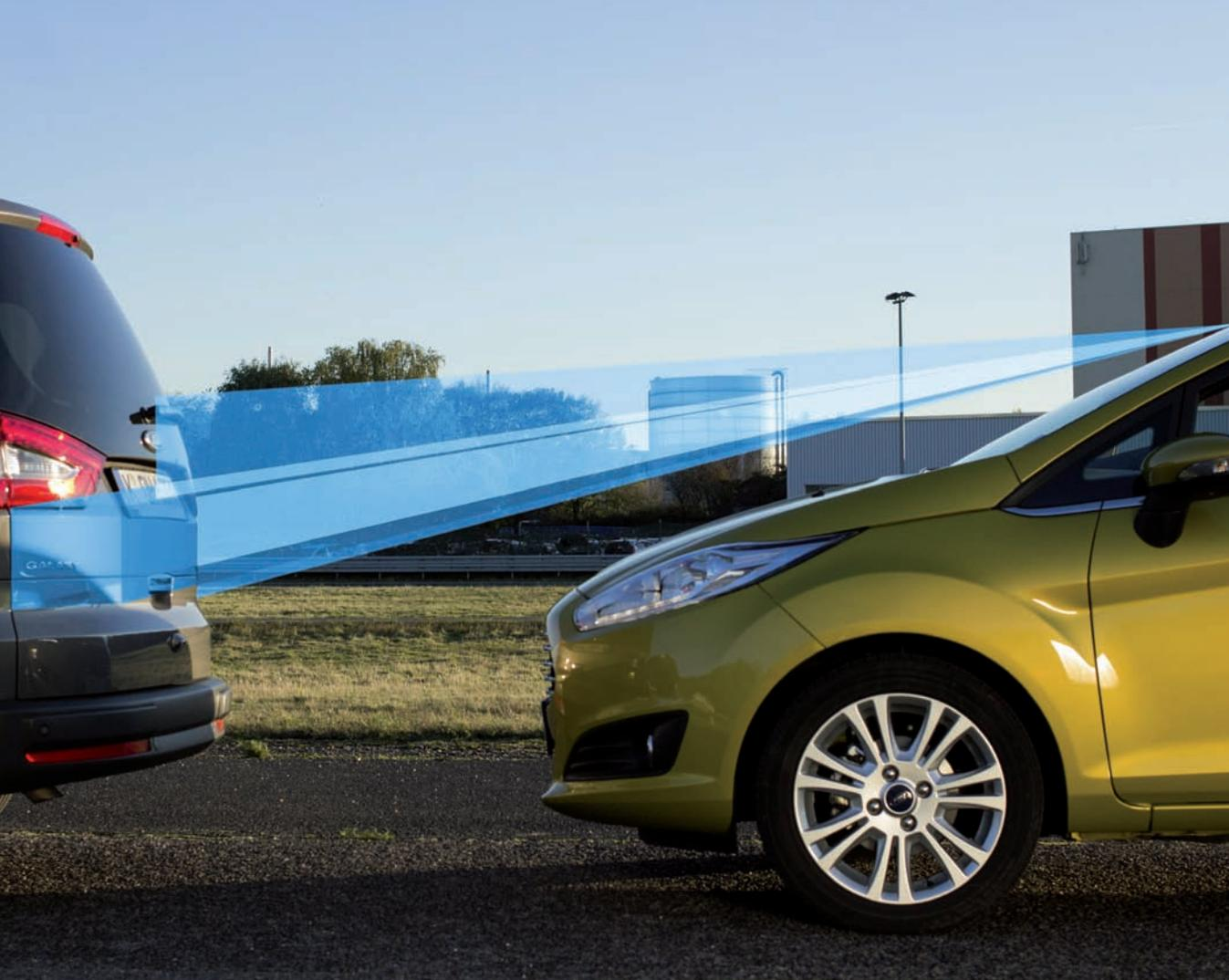
En este caso, una vez detectada la situación de peligro, el sistema interviene de forma autónoma, sin avisar al conductor de dicha situación, y llegando a evitar el impacto cuando la diferencia de velocidad entre nuestro vehículo y el de delante es inferior a 15 km/h, o atenuando dicho impacto cuando dicha velocidad relativa se sitúa entre 15 y 30 km/h.
