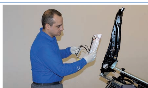
10 Desmontaje del airbag lateral. (*)
