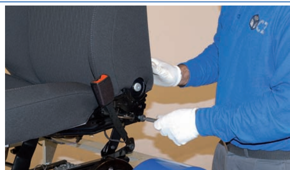
6 Desmontaje del respaldo.
