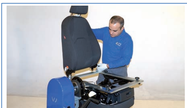
7 Colocación del respaldo en el soporte.
