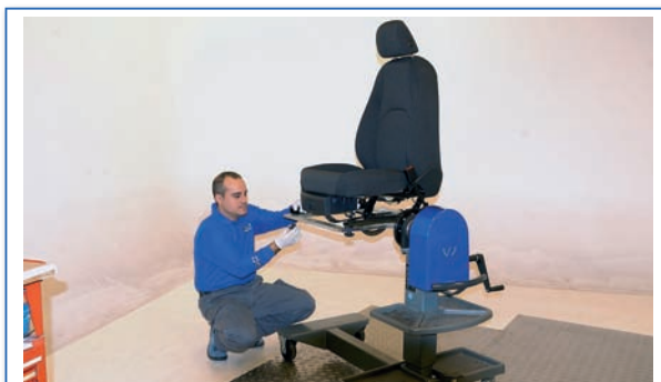
5 Colocación del asiento en el soporte de sujeción.
