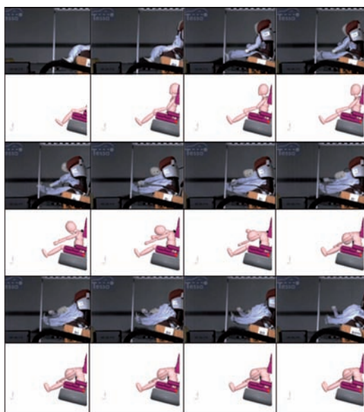
P6: fotografías del crash test de colisión frontal Vs simulación realizada.
