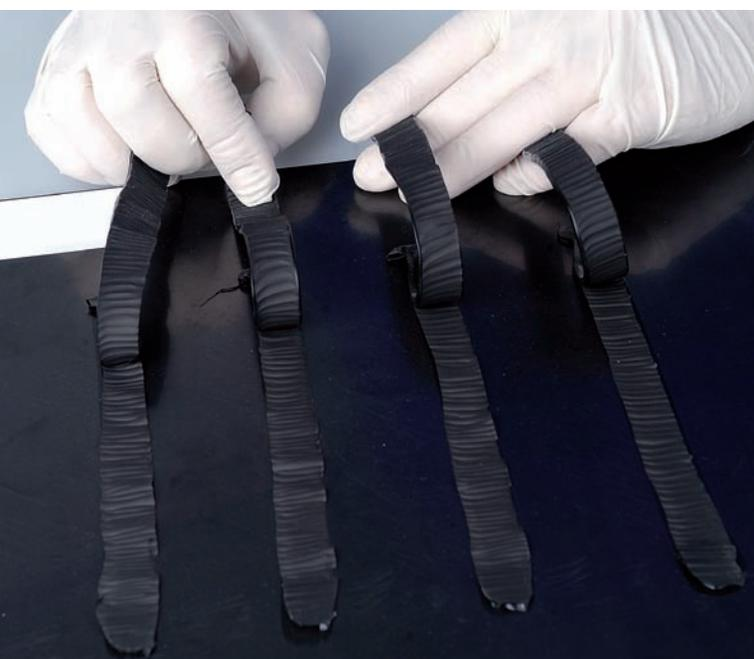
Ensayos de pelado.
