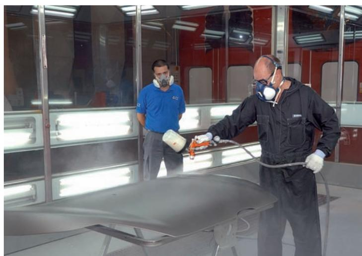
En cuanto a su aplicación, se recomienda una capa media, aplicada a todas las piezas a repintar y, a continuación, una capa completa, evitando la aplicación de capas muy cargadas. ☺
