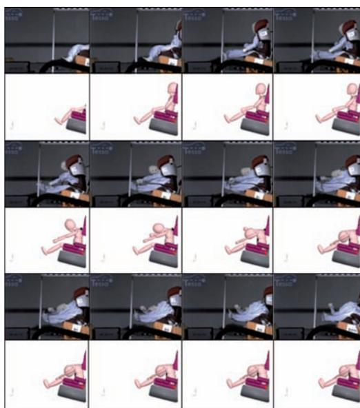
*P6: fotografías del crash test de colisión frontal Vs simulación realizada.*
