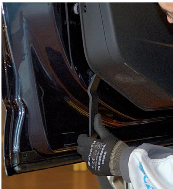
Estas palancas no dañan plásticos, ni pinturas y permiten trabajar en lugares reducidos, por ejemplo, en interiores de puertas, guanteras, interiores de motor, etc.
