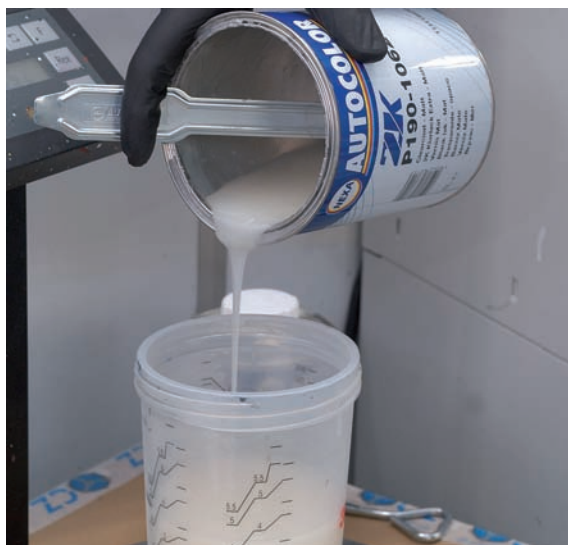
Preparación del barniz.
