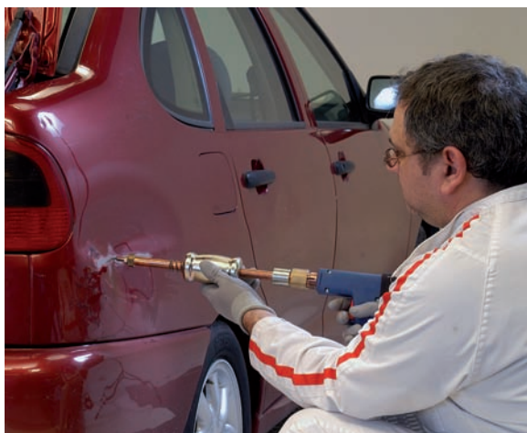
Desabollado de la chapa desde el exterior.
