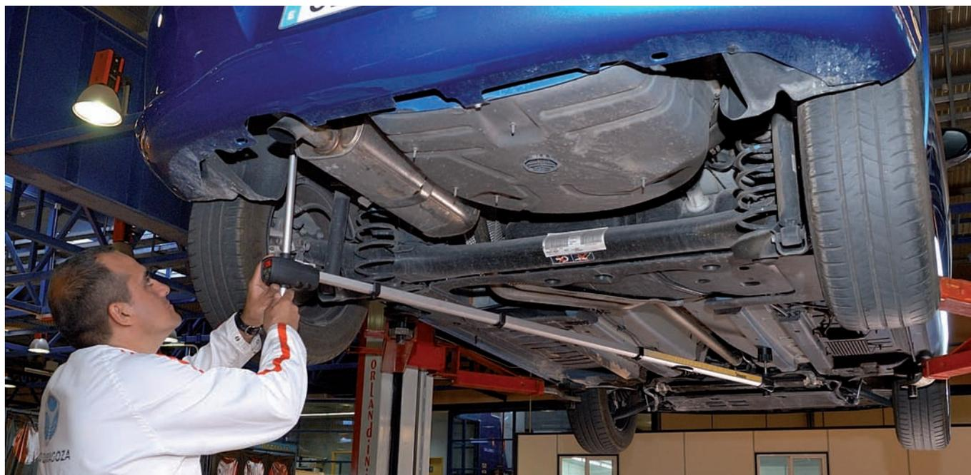
La versatilidad del medidor nos permite realizar mediciones en bancadas, elevadores o en el suelo.
