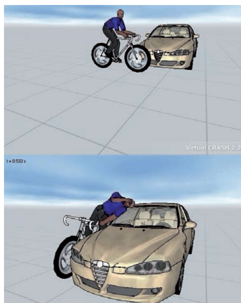
Reconstrucción por ordenador de una colisión fronto lateral entre un turismo y una bicicleta.
