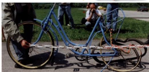
Daños en rueda trasera, donde se observa la forma del paragolpes del turismo.
