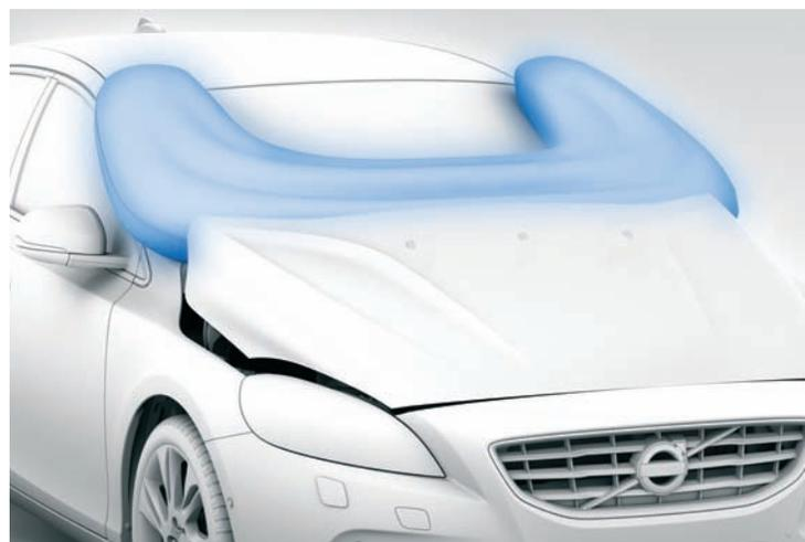
*El airbag de protección para peatones de Volvo se despliega desde la parte posterior del capó y protege al peatón de un severo impacto contra las partes más agresivas del frontal del vehículo.*
