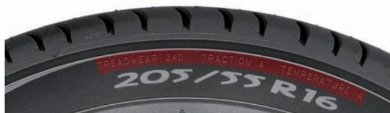
**Treadwear:** Índice comparativo de desgaste del neumático, entre 100 a 300. A mayor índice mayor duración al desgaste.
