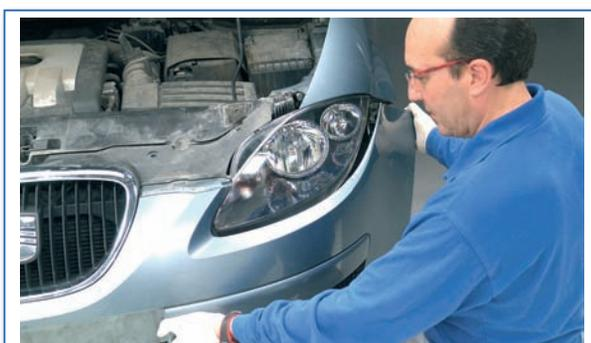
**9** Montaje final del faro en el vehículo.
