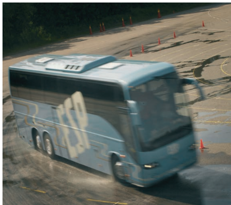
El ESP estabiliza al autobús en maniobras críticas durante la conducción y reduce el riesgo de derrape.
