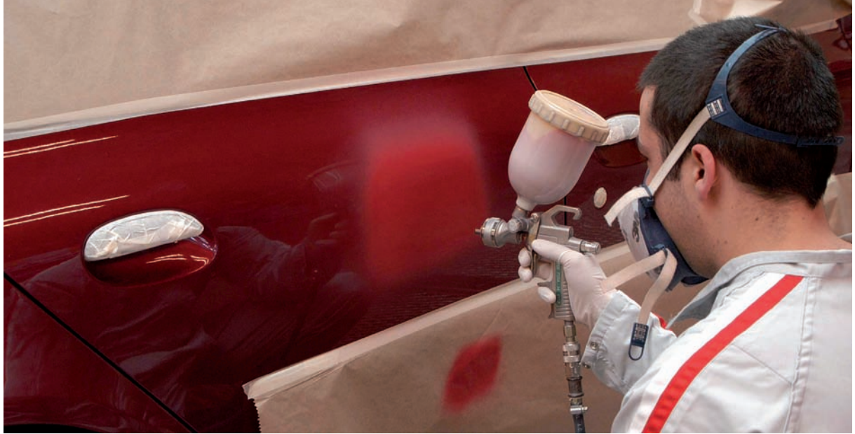
Aplicación de aparejo de la tonalidad adecuada.
