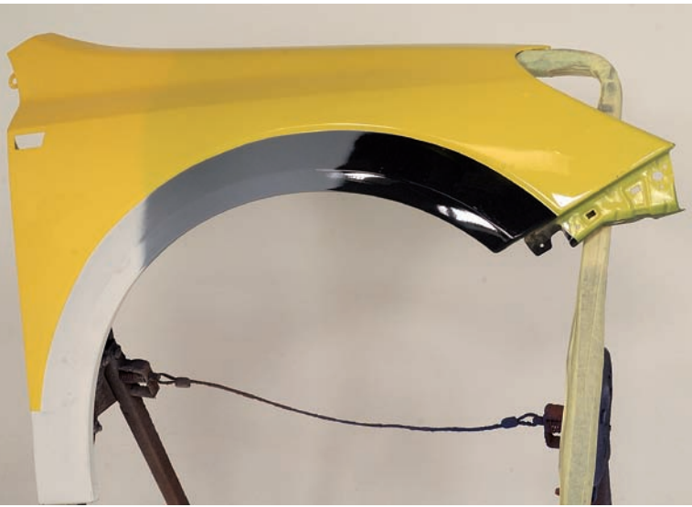
Aplicación de una misma pintura de acabado sobre 3 fondos de distinta tonalidad.
