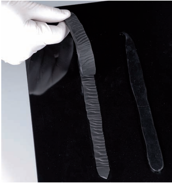
Ensayo de pelado sobre vidrio serigrafiado.
