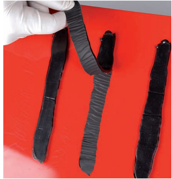
Ensayo de pelado sobre chapa pintada.
