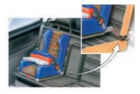
de instalación han surgido nuevos tipos de sillas de seguridad, con anclajes de tipo universal, que facilitan la instalación y compatibilidad de una misma silla en vehículos distintos.
