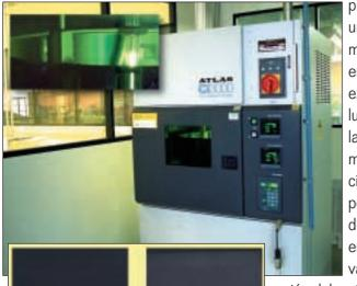
probetas que se someten a un ensayo de envejecimiento acelerado. En dicho ensayo, las probetas están expuestas a una radiación luminosa de espectro similar a la luz solar, especialmente en el rango de radiación ultravioleta, y de forma periódica se simulan ciclos de Iluvia. Finalizado el ensayo, no se debe observar variación en la colora-
