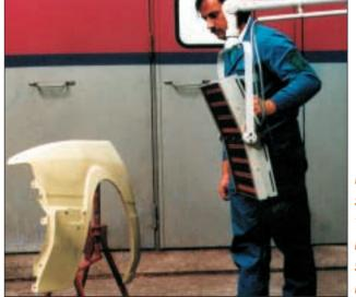
LOS ACTUALES EQUIPOS DE SECADO POR INFRARROJOS TIENEN SU MAYOR CAMPO DE UTILIZACIÓN EN EL SECADO DE PINTURAS DE PREPARACIÓN.
