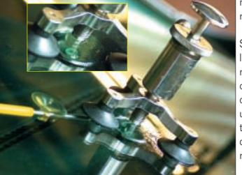
El PRO-VAC es un extractor de aire e inyector de resina en un solo aparato que se monta perpendicular al cristal con la ayuda de un soporte y que lo mantiene en contacto con el daño. Con sucesivos ciclos de vacíopresión se consigue hacer vacío necesario para la extracción del aire que se encuentra atrapado en el interior de la rotura para, a continuación, empezar a llenarlo de resina.
