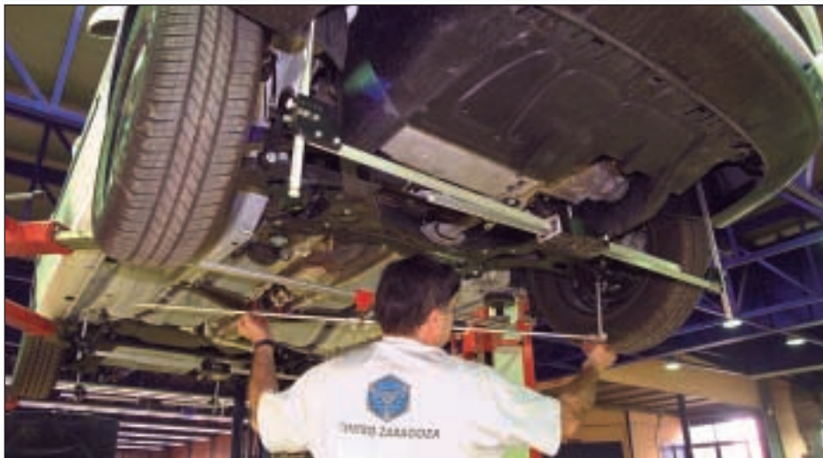
Las cotas estáticas de la geometría de la dirección que se pueden medir directamente con el alineador BATALLA son las siguientes:
