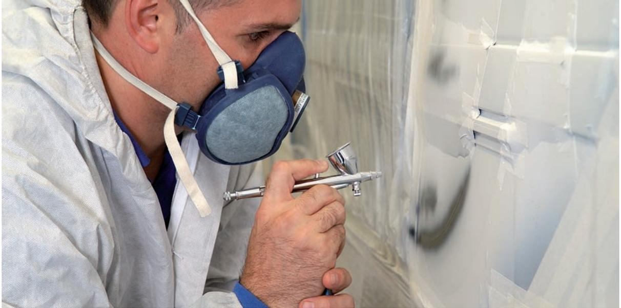
Con todos los básicos ya preparados, la aplicación de los distintos colores se realiza según la división hecha previamente, cargando en la pistola las mezclas de básicos de forma sucesiva hasta concluir con el color más oscuro. Finalmente, tras el secado de las bases, se aplica la capa de barniz para dar el brillo definitivo y proteger el diseño aplicado.
