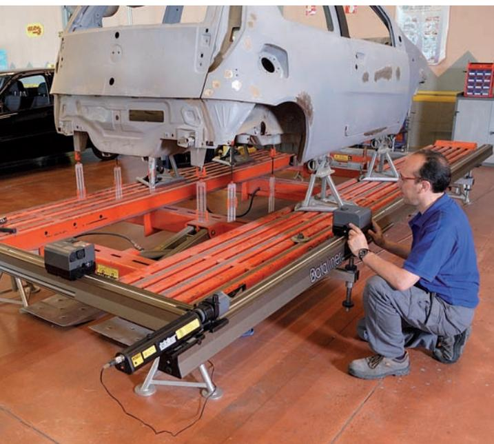
*Bancada Dataliner con sistema de medición óptico.*
