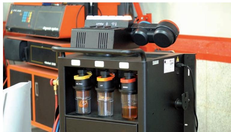
El nuevo refrigerante R1234yf está catalogado como inflamable y necesita condiciones particulares para evitar la posibilidad de un incendio, por lo que se ha dispuesto de un sistema de ventilación para eliminar cualquier posible acumulación de gas en el interior de la máquina.
