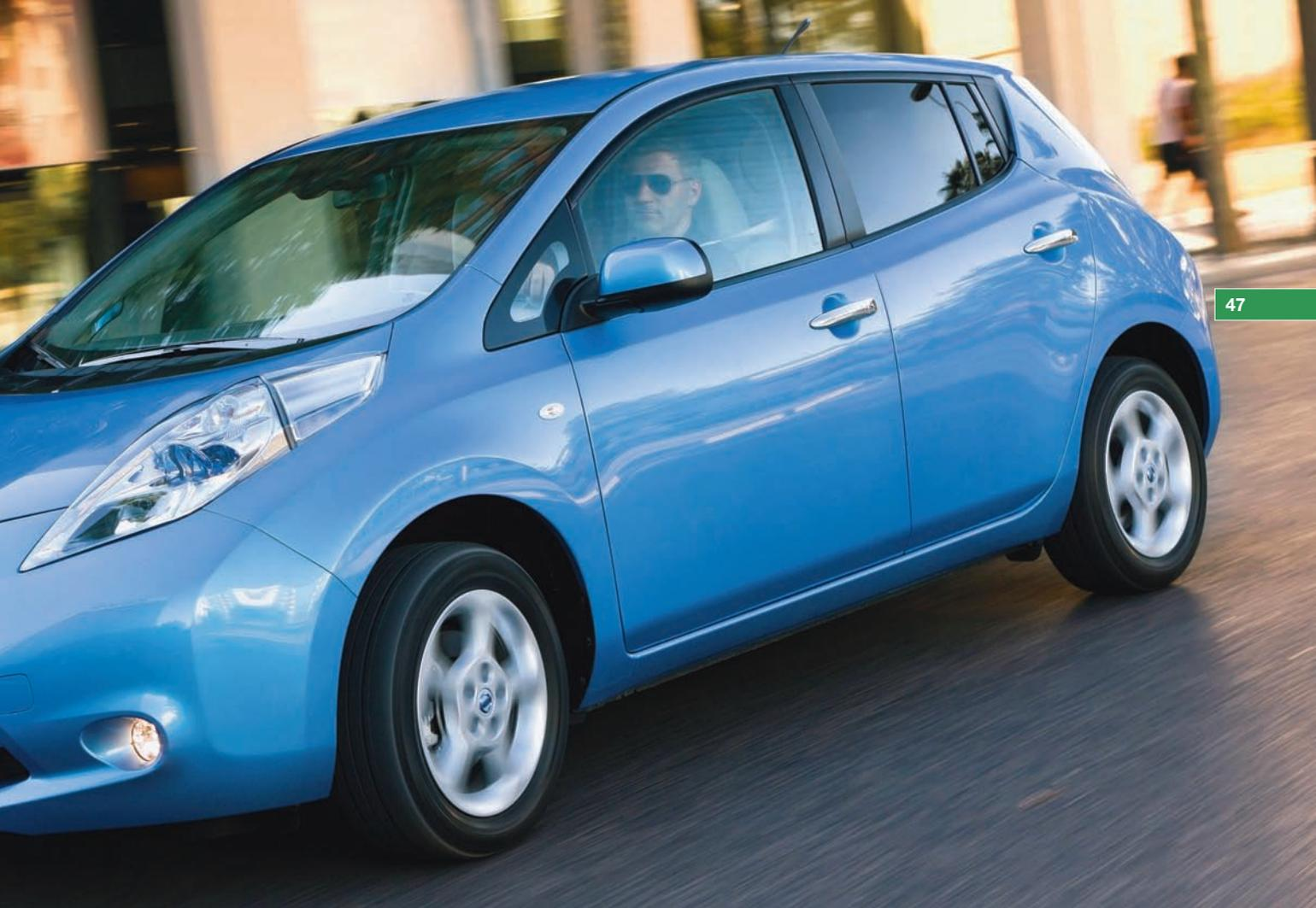
El motor eléctrico funciona gracias a la energía eléctrica suministrada por una batería laminada de iones de litio de 360 V, desarrollada por Nissan, con una capacidad de 24 kWh. El LEAF cuenta con una autonomía de 175 km, dentro del Nuevo Ciclo Europeo de Conducción; hecho que ofrece una práctica alternativa para muchos de los conductores que a diario realizan recorridos urbanos.
