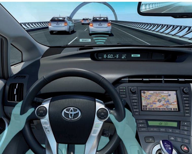
Ante una situación de peligro, el sistema alerta al conductor para que frene.
