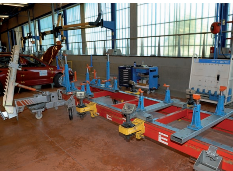
Montaje de una bancada de utillajes.
