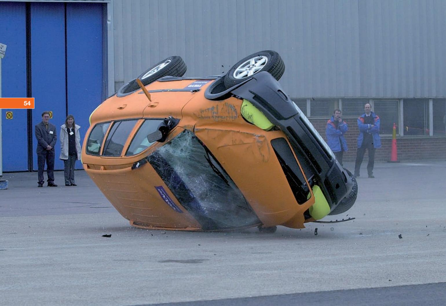
Un vuelco se inicia generalmente cuando el vehículo tropieza con algo, como por ejemplo cuando las cuatro ruedas quedan enganchadas en algún bordillo o pequeño obstáculo, o también cuando hay un deslizamiento o fricción con la superficie de la carretera tras una maniobra con derrape.
