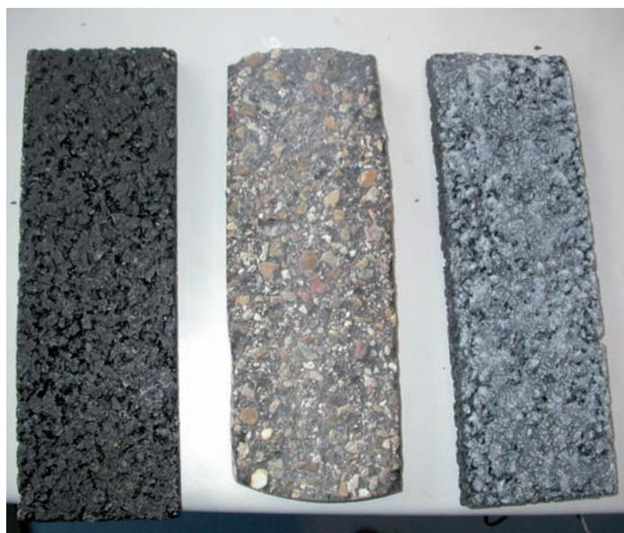
*Probeta convencional, testigo de un tramo de prueba y probeta de laboratorio tratada.*
