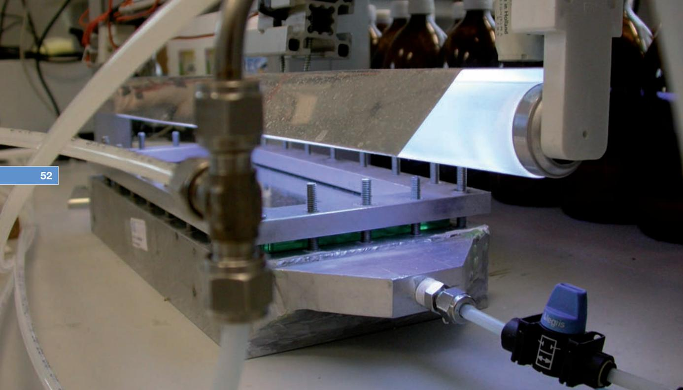
*Reactor fotocatalítico para determinar el rendimiento del  $TiO_2$  en la eliminación de  $NO_x$ .*
