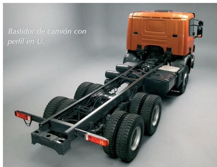
*Bastidor de camión con perfil en U.*
