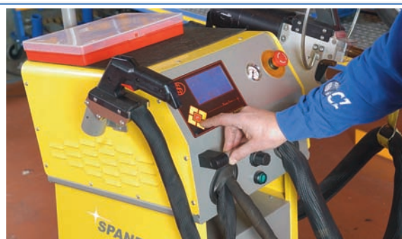
2 Preparación de la máquina de resistencia eléctrica para el soldeo por empuje.
