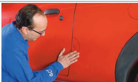
1 Identificación y delimitación del daño.
