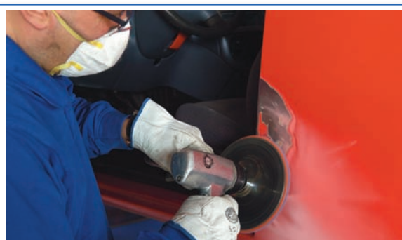
4 Lijado de pintura en la zona (hundimiento de la chapa) donde se suelda la punta del martillo y en la zona donde se sitúa la masa.
