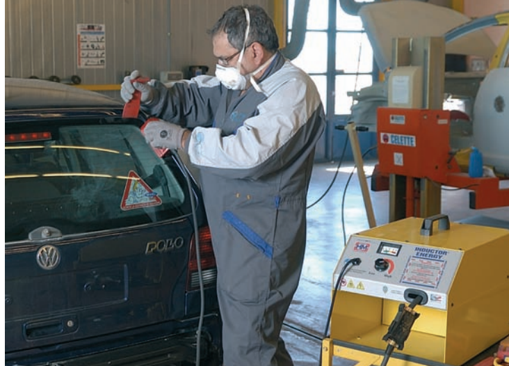
Desmontando una luna con el Glass Releaser.
