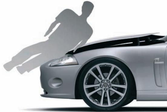
*Capó activo. En caso de atropello el capó se eleva automáticamente, incrementándose la distancia entre el peatón y los elementos mecánicos más rígidos.*
