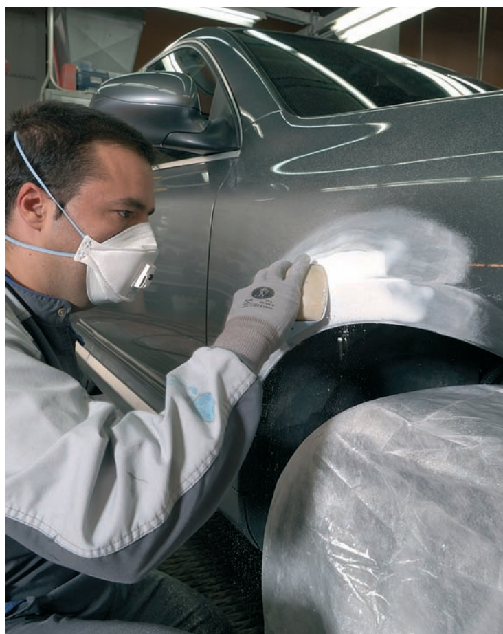
Lijado manual con ayuda de taco.
