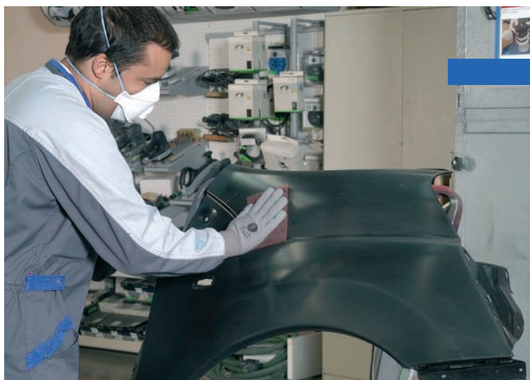
Lijado fino o "matizado" con abrasivo tridimensional de una pieza nueva.
