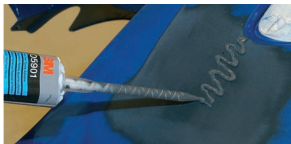
Reparación de arañazo.
