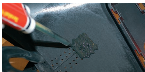
Reparación de grieta por adhesivo.
