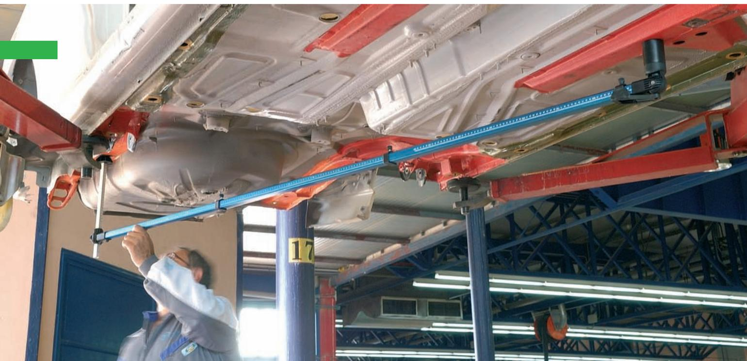
*Con el Monocross es posible realizar mediciones en la plataforma de la carrocería de forma precisa y sencilla.*
