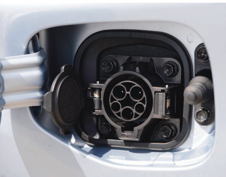
Detalle de la toma de carga eléctrica del Prius Plug-in.
