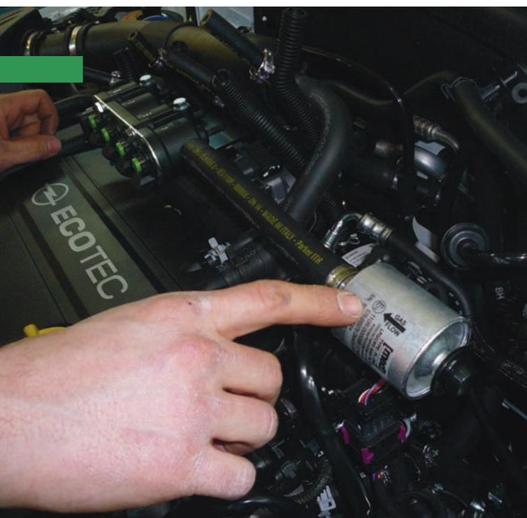
*Una válvula transforma el GLP en gas para su uso en el propulsor.*
