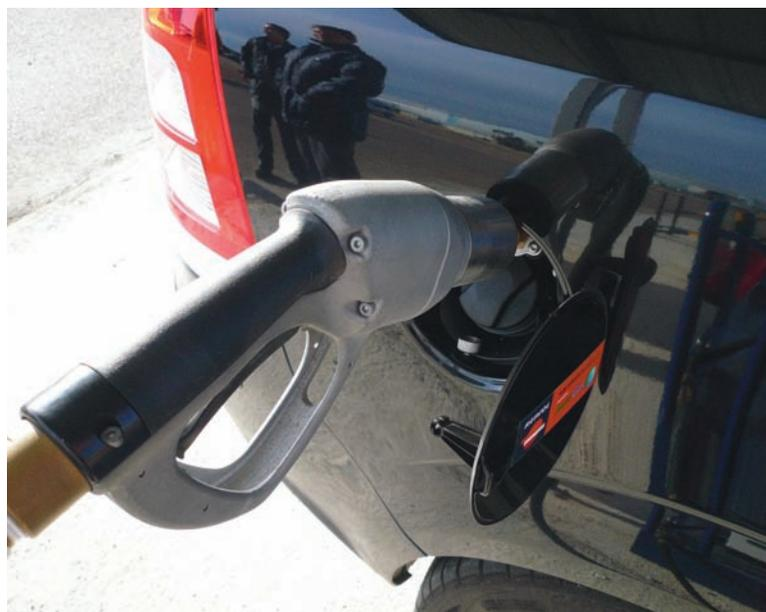
*Detalle del repostaje de un vehículo con GLP.*
