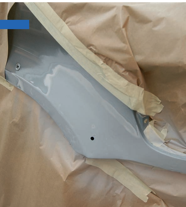
Imprimación epoxi aplicada para proteger el metal.
