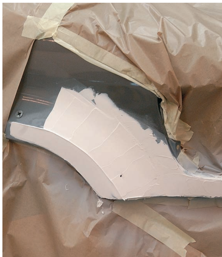
Aplicación de la masilla sobre la imprimación.
