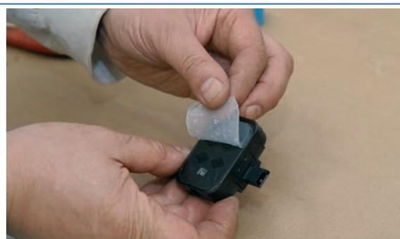
**2** Retirar el gel residual del sensor.
