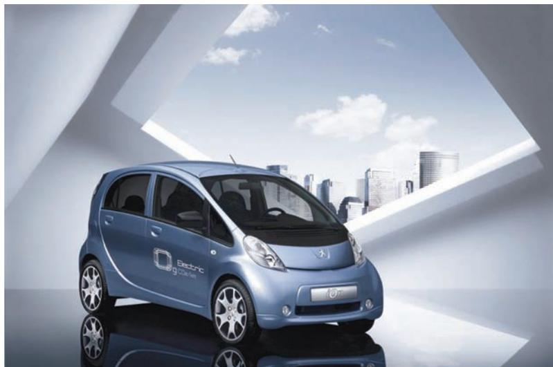
*Soy un utilitario urbano de cuatro plazas, con potencia de 47Kw y velocidad máxima de 130km/h y en 6h me recargo completamente en una toma de 220V.*
