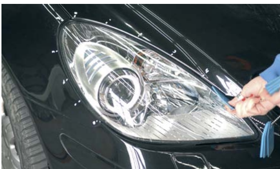
Verificación de holgura en capó y aleta delanteros.
