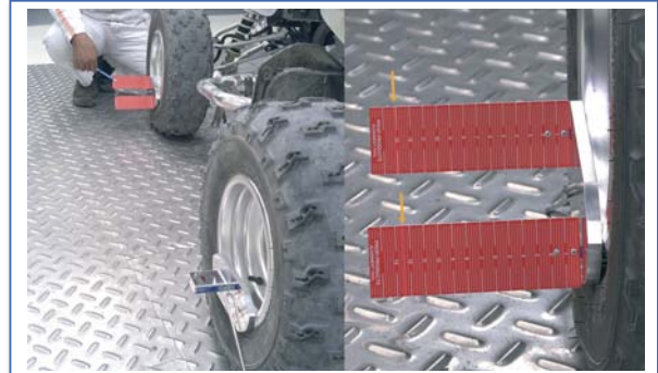
6 Medición del paralelo, dando alineación incorrecta.
