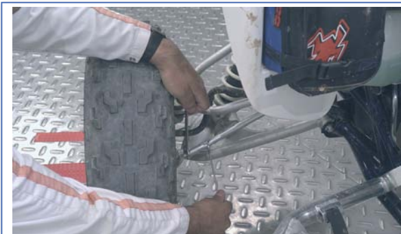
7 Ajuste de la alineación, regulando las bieletas de la dirección.
