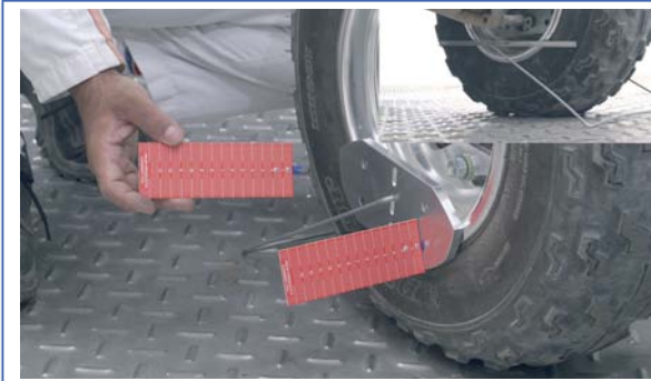
5 Colocación de los soportes y de las tarjetas en las ruedas delanteras.
