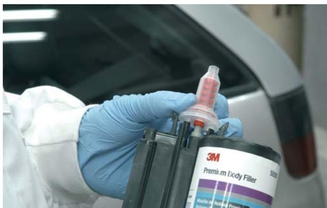
Colocación de la boquilla mezcladora.
