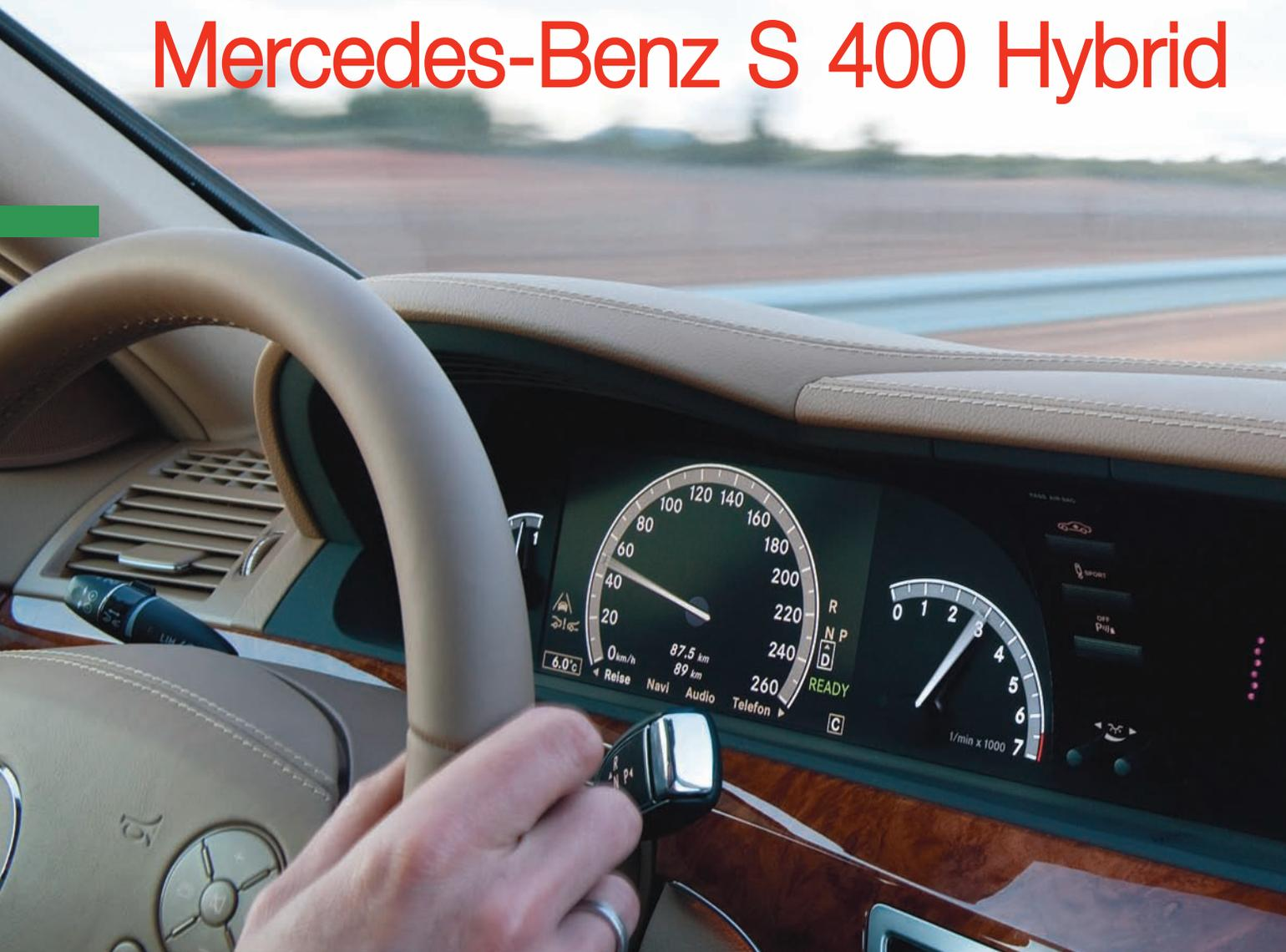
**A**llá por verano del 2009 comenzó a comercializarse en Europa el primer modelo de Mercedes-Benz con propulsión híbrida. Se trata del modelo S 400 del fabricante alemán que, dotado de una mecánica de gasolina V6 y un motor eléctrico, alcanza consumos combinados de combustible del orden de los 7,9 litros cada 100 kilómetros; con emisiones de alrededor de 186 gramos de CO<sub>2</sub>/km.
