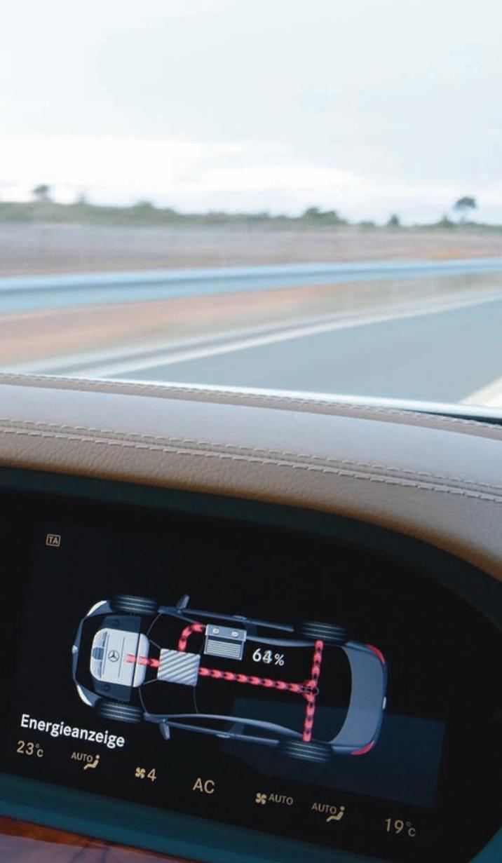
*El sistema 'Star/Stop' detiene el motor cuando el vehículo se para tras circular a una velocidad inferior a los 15 km/h; por ejemplo, cuando lentamente frenamos nuestro vehículo al llegar a un semáforo. \_\_\_\_\_*
