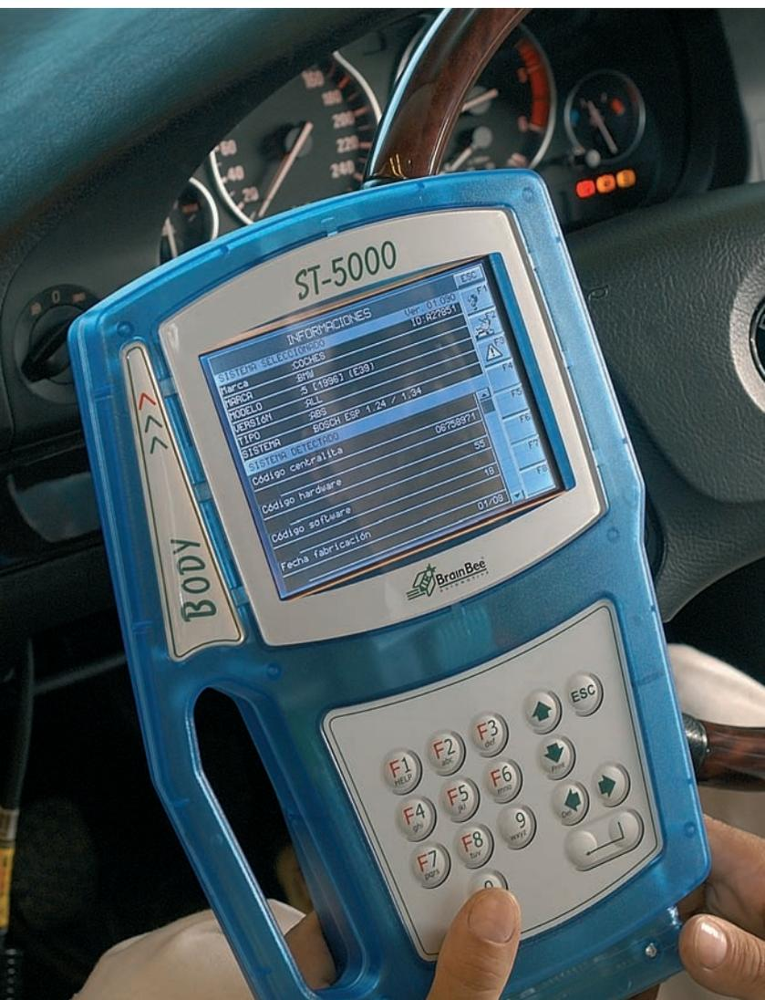
Equipo multimarca para el diagnóstico de sistemas electrónicos incorporados en los vehículos y adaptado a las necesidades generadas en los trabajos realizados en el área de carrocería.
