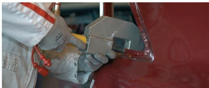
La **unión mediante adhesivo** se utiliza en fabricación para la unión de zonas de las piezas en las que generalmente no se tiene acceso para la soldadura por resistencia.
