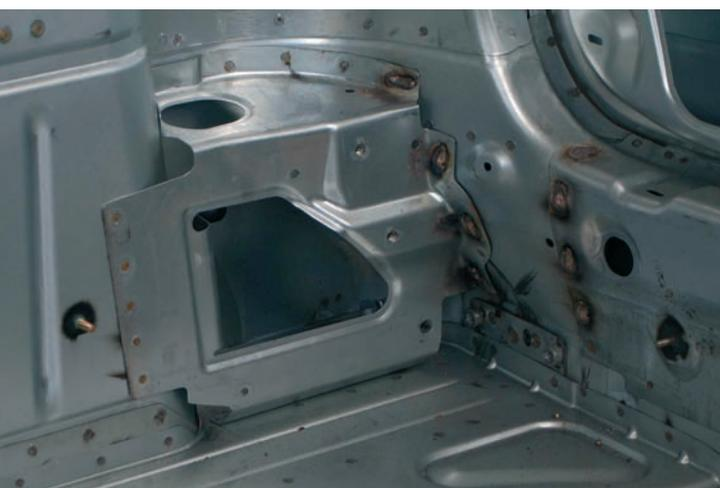
La **soldadura láser** permite realizar uniones con una zona afectada térmicamente muy localizada.
