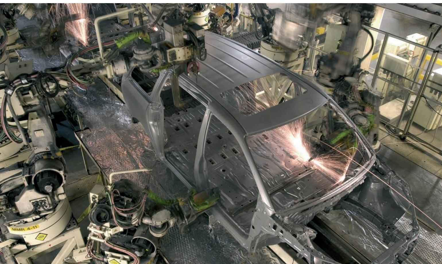
**E**n la fabricación de una carrocería de automóvil se utilizan diversos sistemas de unión, como son la soldadura por puntos resistencia, la soldadura laser, la soldadura laser con material de aporte, la soldadura MIG/MAG y la soldadura MIG brazing entre otras. También se utilizan sistemas de unión mediante adhesivos estructurales y semiestructurales.
