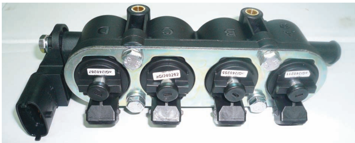
Válvulas de Inyección
