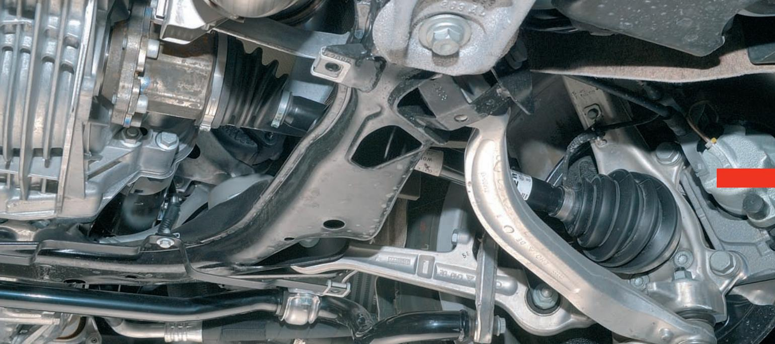
Esta junta es de engrase permanente y se caracteriza por su reducido volumen. Tiene un rendimiento muy elevado y muy poca resistencia al deslizamiento.
